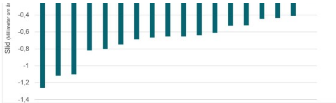
Figur 4 Gennemsnitligt slid målt på siderne af blandekaret målt 10 og 30 cm over bunden.
